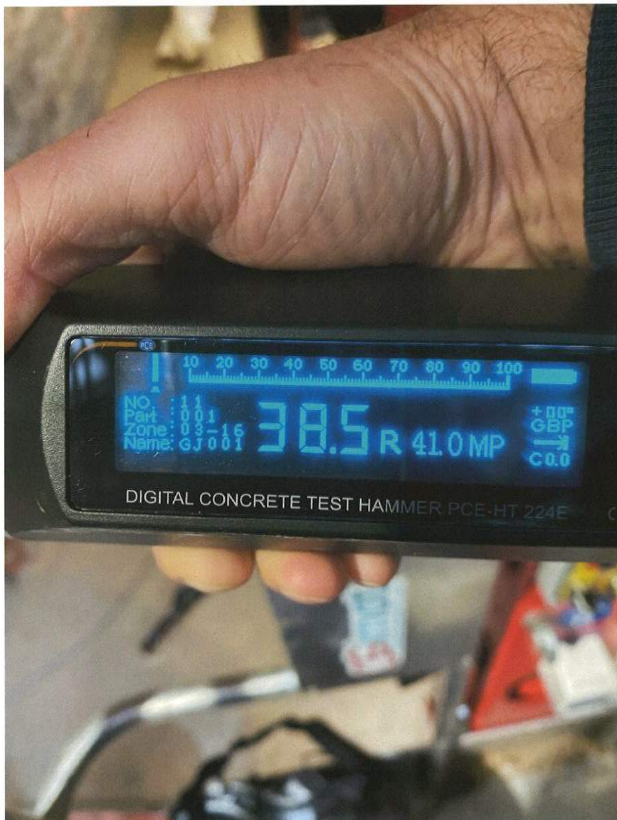
Essais sclérométrique, béton OK
