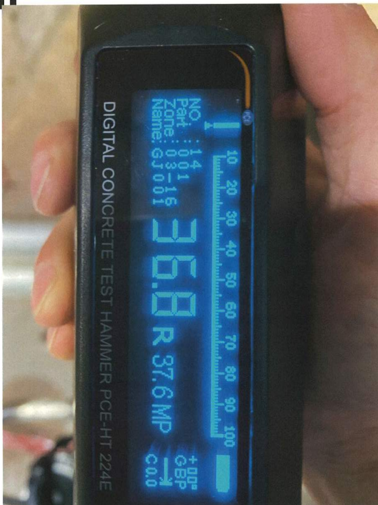
Essais sclérométrique, béton OK
